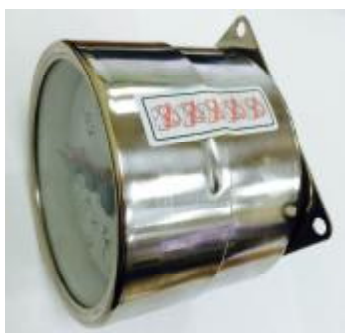
Рисунок 11 – Пломбировка с помощью наклейки
